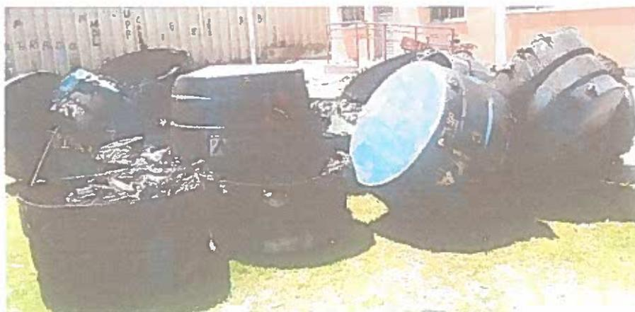
Caixas d'água deformadas após o incêndio
